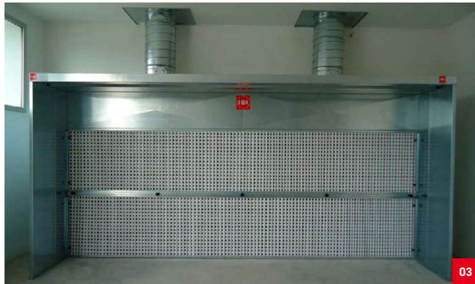
03. cabina di verniciatura a secco Drying painting booth. Ухая окрасочная камера.
