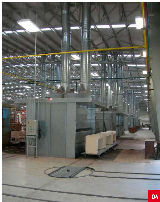
04. Espulsioni da cabine verniciatura doppio velo acqua. Outlet piping of double veil water booths. Отводной трубопровод от окрасочных камер с двойной водяной завесой Лакокрасочная промышленность и другая продукция для древесины.
