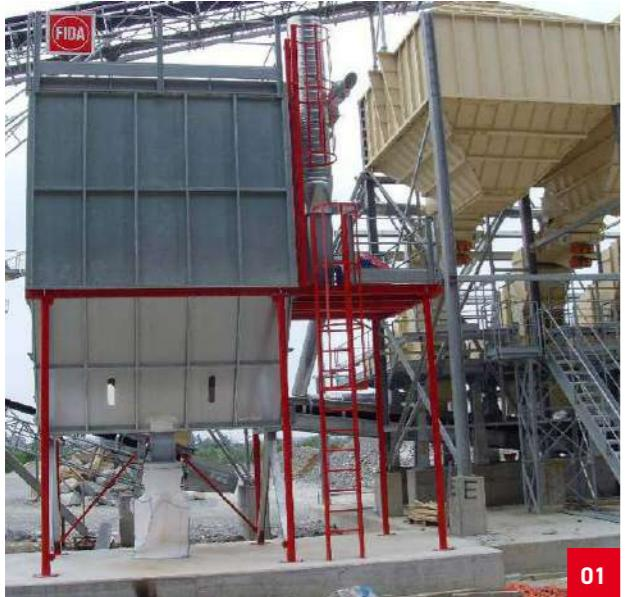
**01. 03. 03.1** Filtro funzionante in depressione, a pulizia delle maniche con ventilatore di soffiaggio.
